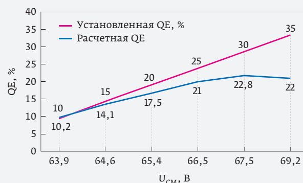
Рис. 13. Зависимость установленной и расчётной квантовой эффективности на детекторе IDQube-NIR-FR-MMF-LN от напряжения смещения встроенного лавинного фотодиод
